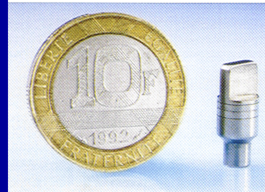
Source scellée de ^{192}\text{Ir} pour gammagraphie (activité max. : 4,9 TBq).
